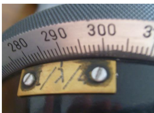
Rys. 7. Wskaźnik wartości kąta azymutu pierwszego wektora własnego ćwierćfalówki
