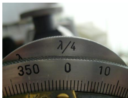
Rys. 6. Włączenie ćwierćfalówki w bieg światła
