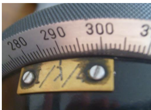
Rys. 6. Wskaźnik wartości kąta azymutu pierwszego wektora własnego ćwierćfalówki
