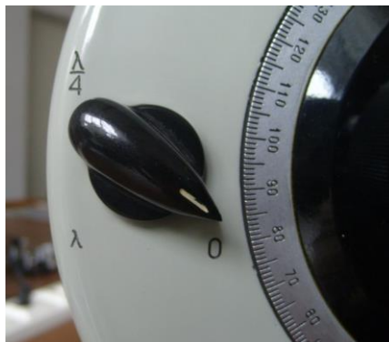
Rys.3. Pokrętło, służące do wstawiania ćwierćfalówki lub jednofalówki w bieg wiązki
