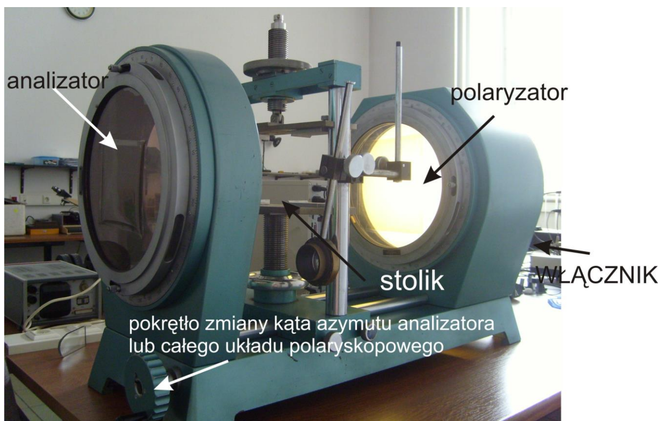
Rys.1. Układ polaryskopowy (polaryskop budowlany)
